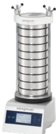
La **EML 200 Premium** est équipée d'une interface de données conviviale et permet de choisir simplement l'amplitude. Elle convient parfaitement aux utilisateurs qui ont des exigences spécifiques pour une analyse granulométrique précise et reproductible.
